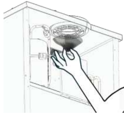
Foto 11: Processo di rimozione/collocamento del filtro
