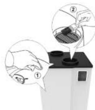
Foto 23: Pulizia di manutenzione della macchina
