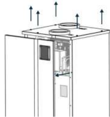
Foto 6: Smontaggio del corpo anteriore
